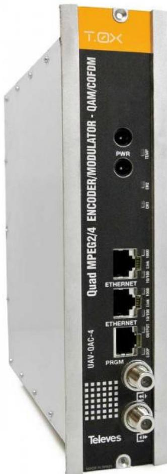
Digitalni enkoder/modulator je uređaj koji generiše digitalni TV kanal (multipleks) iz A/V izvora, poput kamere, računara, STB ili TV SAT risivera. **4 AV signala na ulazu se pretvaraju u 1 izlazni QAM ili COFDM multipleks na izlazu.**
